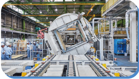
鉄骨ユニットの天井になる部分を 「ユニット反転機」で下向きに反転して作業しやすく
